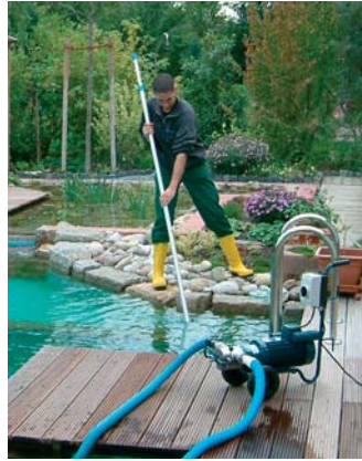
CFP P003 mit einer Förderleistung von max. 14 m 3 /h
